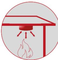
При контакте с огнем устройство самостоятельно активируется с оповещающим хлопком и мгновенно тушит очаг возгорания
