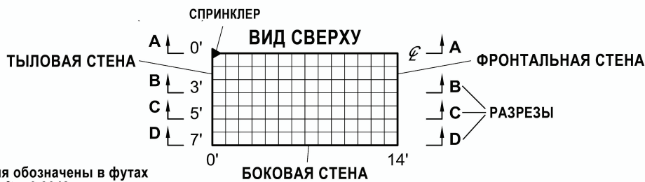
Рис. D. Вертикальный срез зоны орошения на разных боковых удалениях от оросителя
