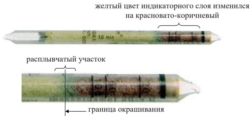
Рис. 15. Индикаторная трубка «Water vapour 20/a-P» после проведения 10-минутного измерения (пример)
