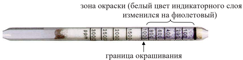
Рис. 11 Индикаторная трубка «Carbon dioxide 100/a-P» после проведения измерений (пример)
