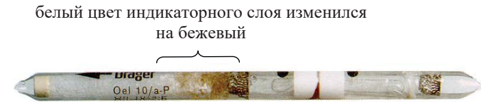
Рис. 7 Индикаторная трубка «Oil 10/a-P» после проведения измерений (пример)
