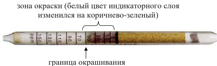
Рис. 9 Индикаторная трубка «Carbon monoxide 5/a-P» после проведения измерений (пример)
